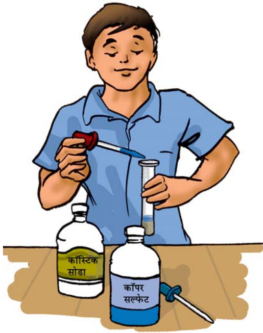
चित्र 2.2 प्रोटीन के लिए परीक्षण
